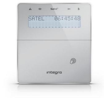
Su fuente de alimentación son dos pilas CR123A 3 V. El estado de las pilas se está continuamente controlando. El dispositivo funciona en modo activo y en modo de espera (ahorro de energía al cabo de 20 segundos de inactividad). Para ahorrar más energía es posible desactivar el lector de tarjetas de proximidad (por ejemplo, en caso de que el sistema de alarma no va a controlarse a través de ellas).
